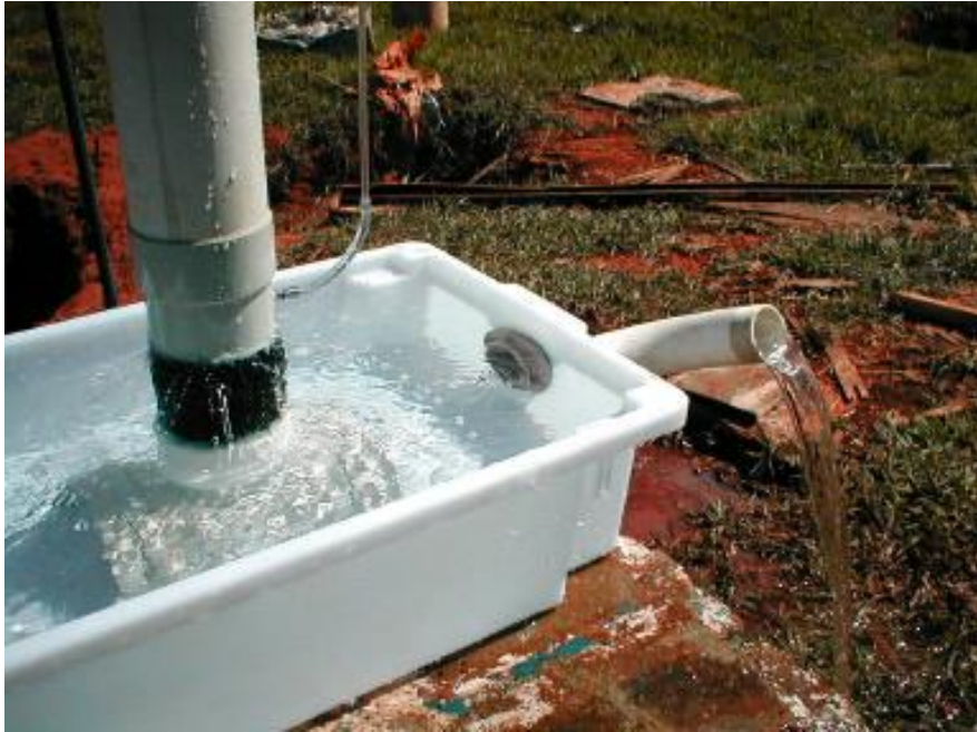
Figura 37 – Ensaio de permeabilidade horizontal.
