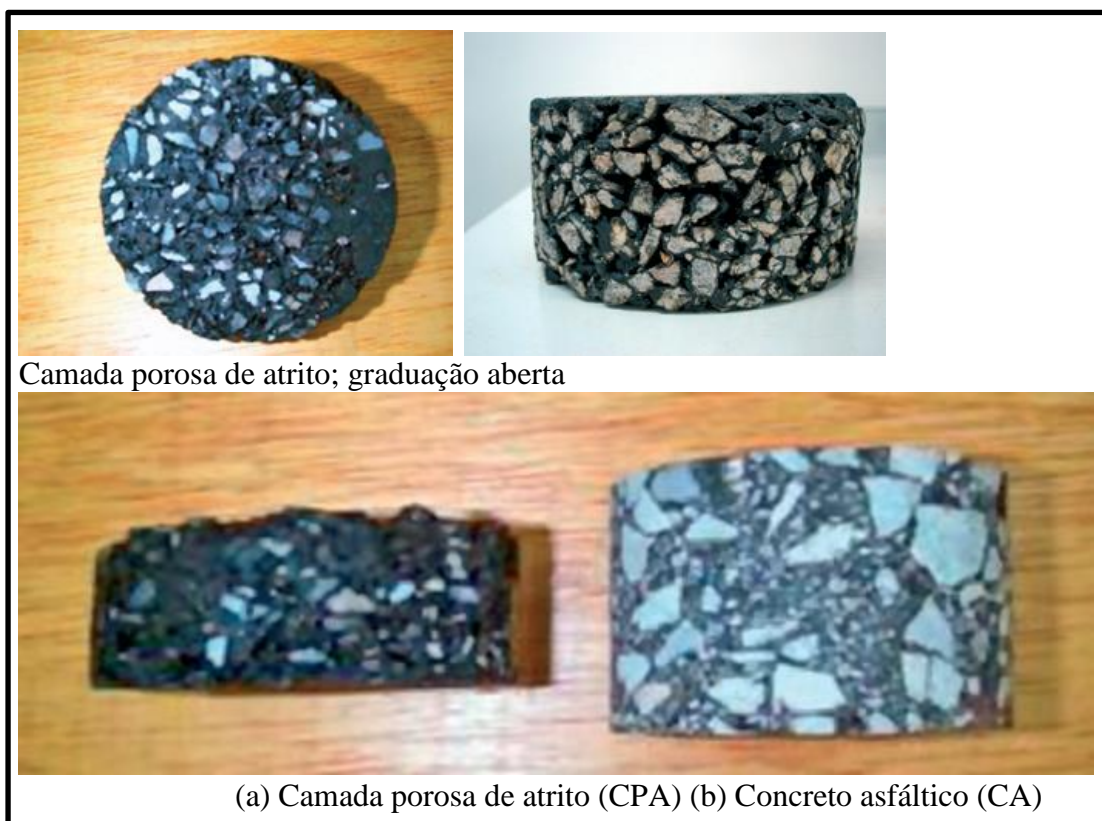
Figura 22 - Corpos-de-prova moldados em laboratório CA (densa), e CPA (aberta ou porosa).
