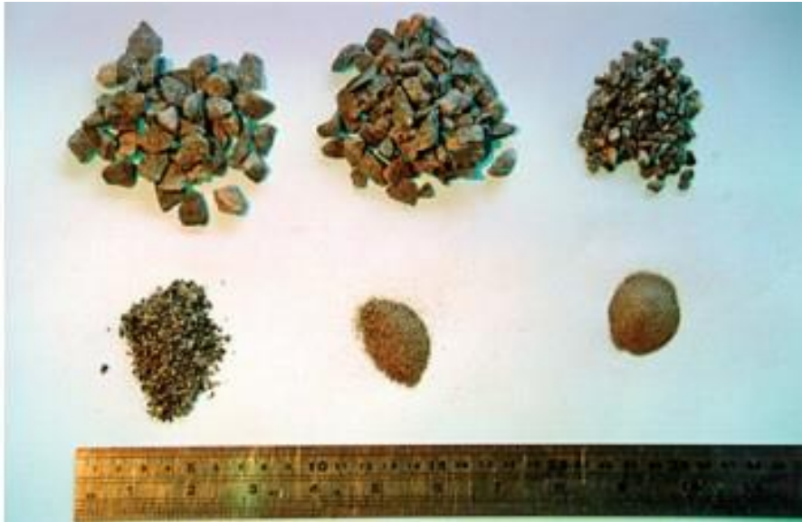
Figura 21 – Exemplo de várias frações de agregados e filer que compõem um concreto asfáltico – mistura densa ou bem-graduada e contínua.
