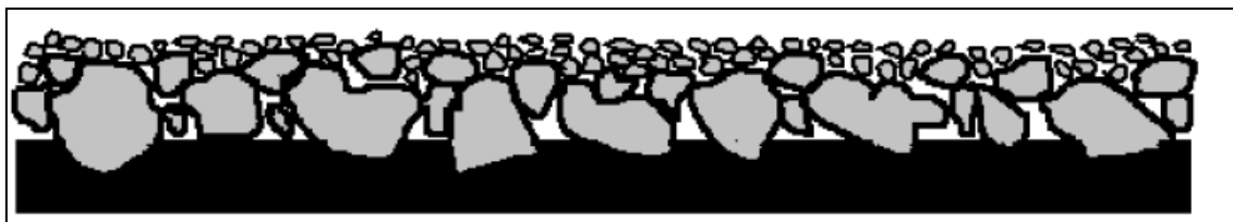
Figura 6 – Ilustração do tratamento superficial triplo (TST).
