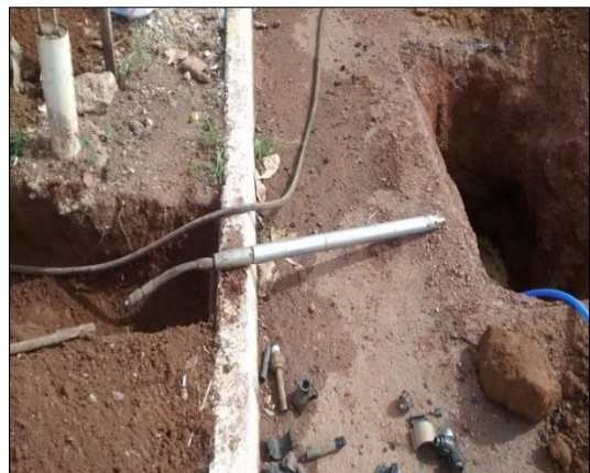
Figura 16 - Haste pneumática da perfuratriz. Fonte: Do autor (2018)
