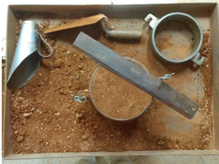
Figura 8- Ensaio de Compactação.
