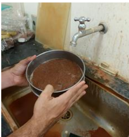
Figura 4- Lavagem do material pulverulento.
