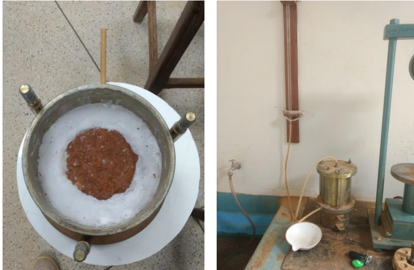
Figura 9- Corpo de Prova (a) Ensaio de permeabilidade (b)
