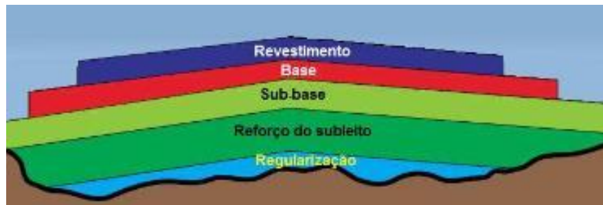
Figura 3 - Constituição do pavimento
