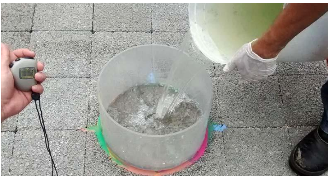
Figura 5- Coeficiente de permeabilidade pelo método de anel de infiltração
