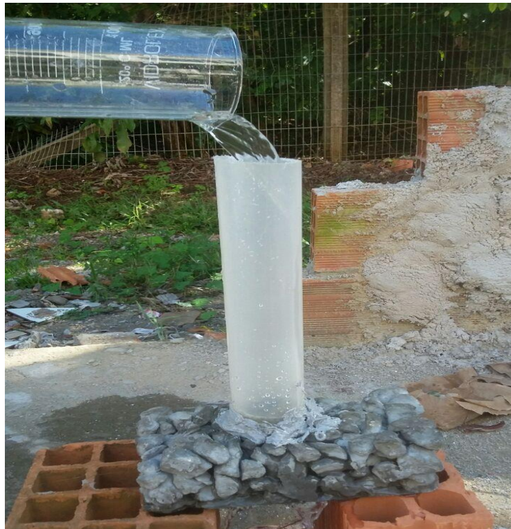
Figura 15: Ensaio de permeabilidade.
