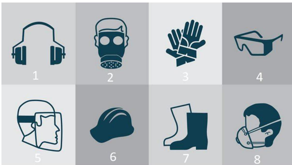
Figura 3 - EPI's da construção Civil
