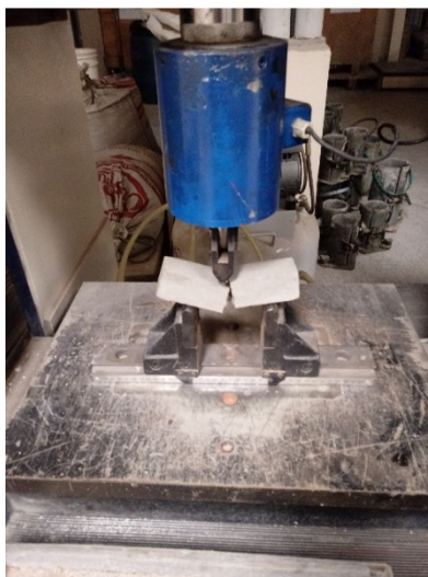
Figura 8 - Ensaio de resistência à tração na flexão
