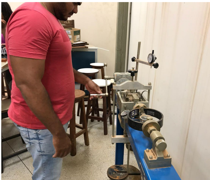
Figura 17: Execução do ensaio de cisalhamento direto manual
