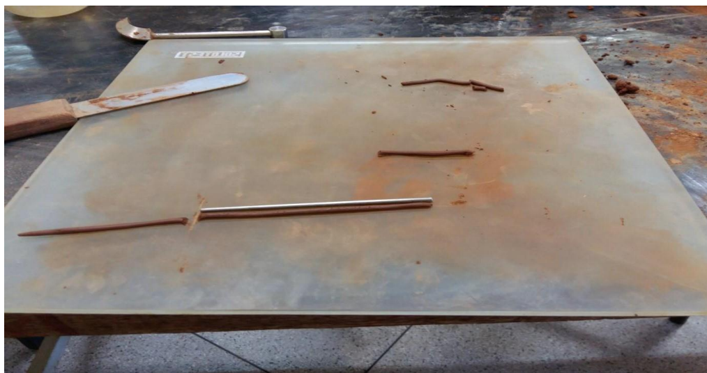
Figura 12: Amostra sendo moldada ao lado do gabarito
