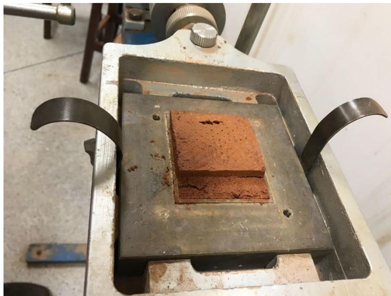
Figura 18: Corpo de prova após ruptura por cisalhamento.
