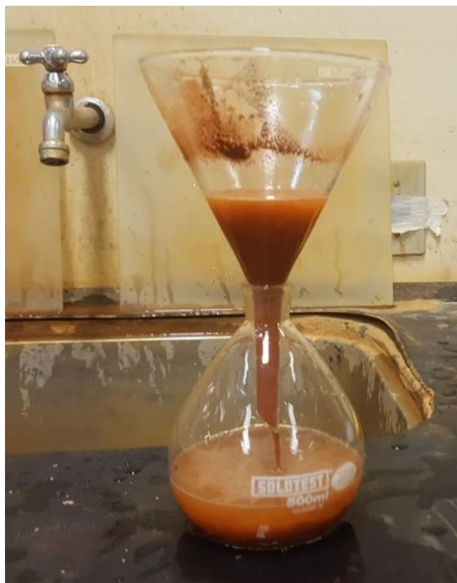
Figura 13: Material sendo transferido ao picnômetro.
