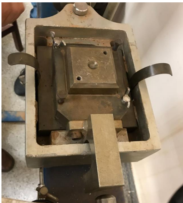
Figura 16: Caixa de cisalhamento instalada.
