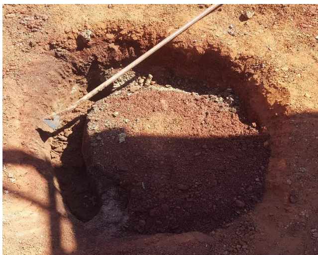
Figura 6: Coleta de amostra deformada.
