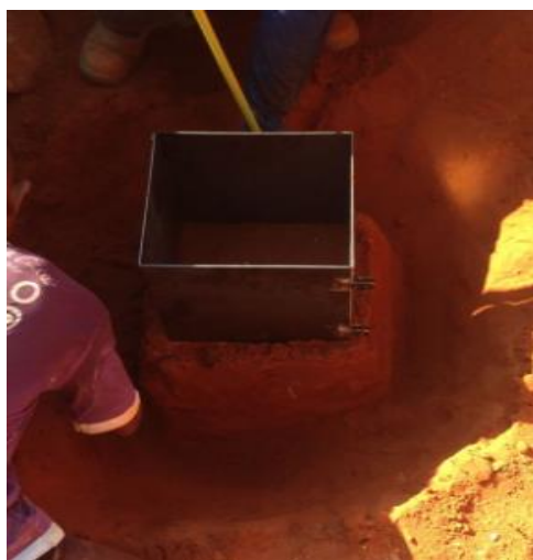
Figura 7: Coleta da amostra indeformada.
