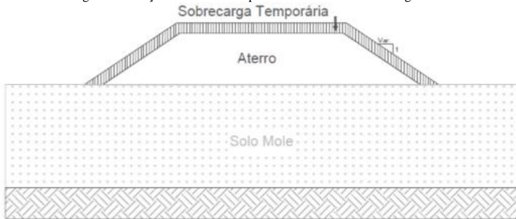
Figura 29 - Seção Transversal Típica de Aterro com Pré-carregamento
