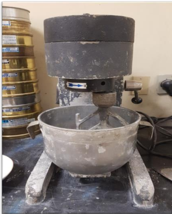
Figura 18: Argamassadeira utilizada na produção da argamassa
