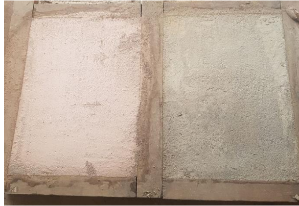
Figura 23: Substrato utilizado para a realização do ensaio a resistência de aderência à tração
