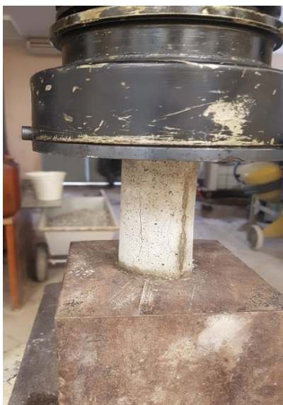
Figura 21: Ensaio de resistência à compressão na Prensa Emic
