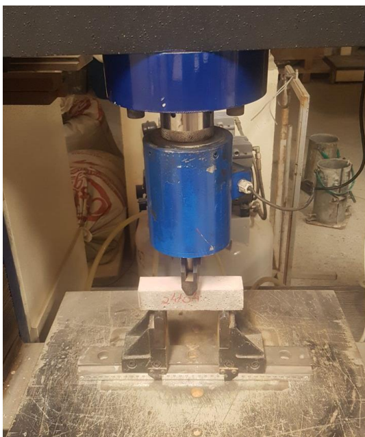
Figura 22: Ensaio de compressão na Prensa EMIC PC 201
