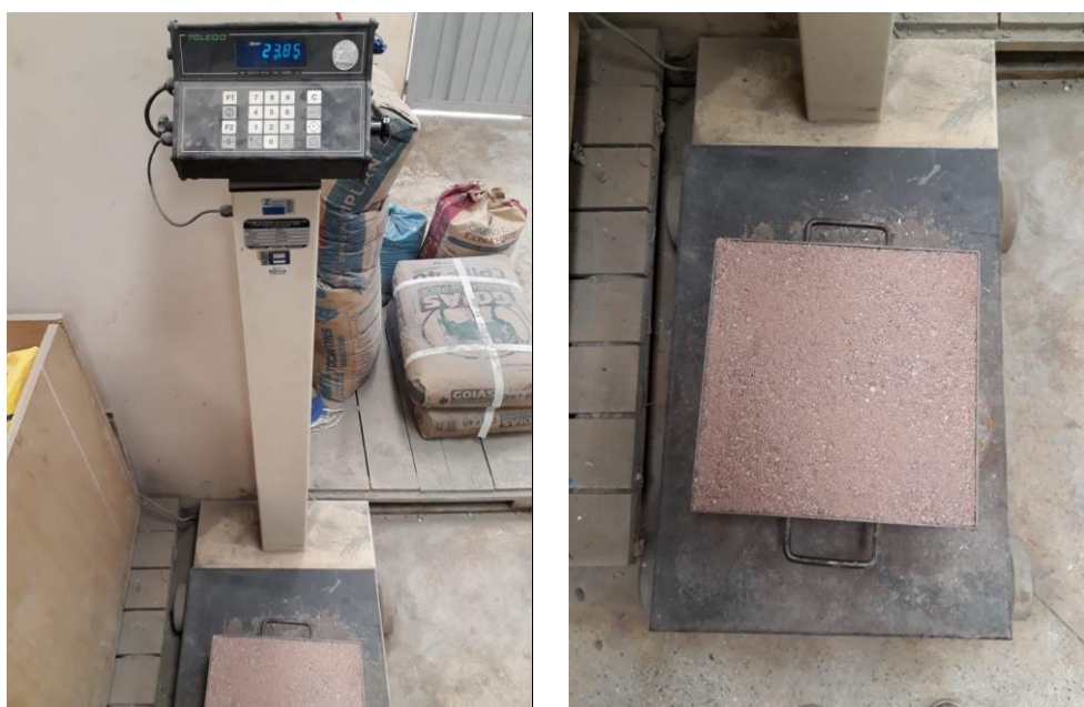
Figura 16: Ensaio de massa unitária
