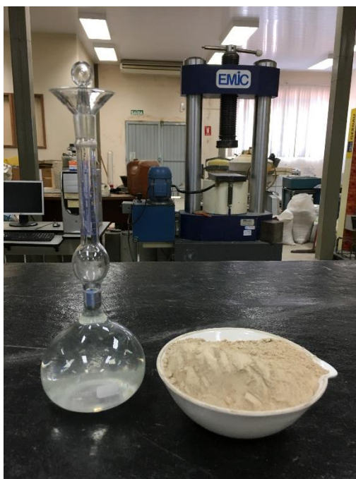
Figura 9: Determinação através do frasco Le Chatelier
