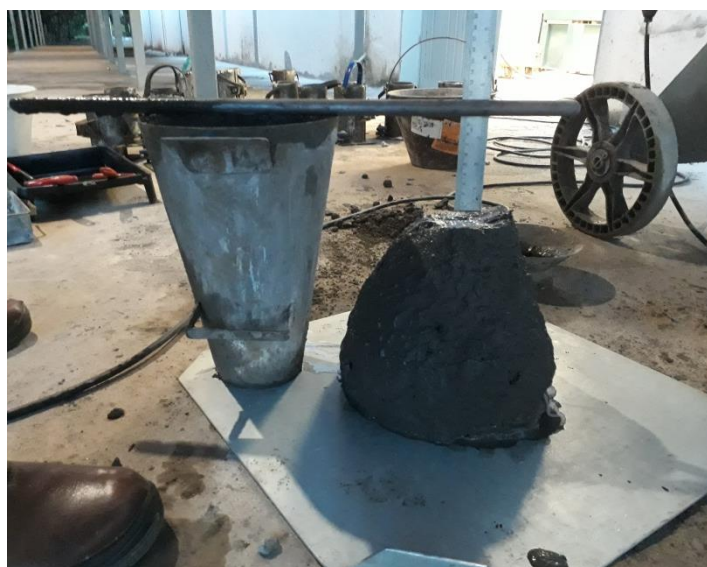
Figura 16: Ensaio abatimento de tronco de cone
