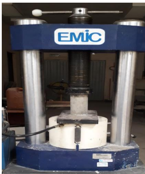
Figura 12: Ensaio de resistência a compressão
