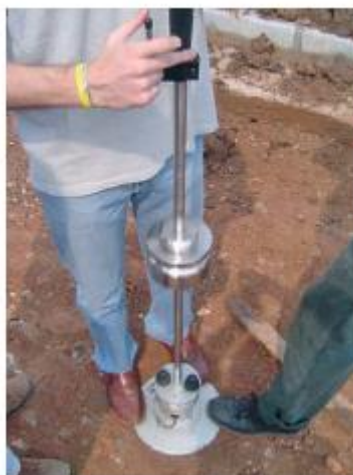
Figura 26 - Equipamento de avaliação semidestrutivo
