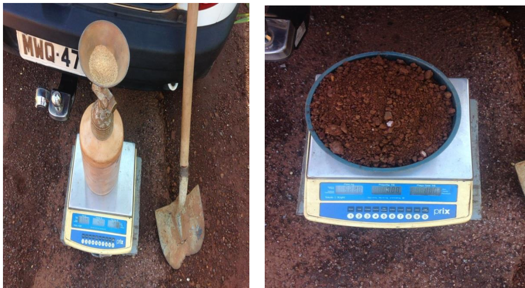
Figura 31 – Ensaio de Densidade ‘in situ’
