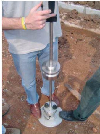
Figura 27 - Equipamento de avaliação semidestrutivo em uso
