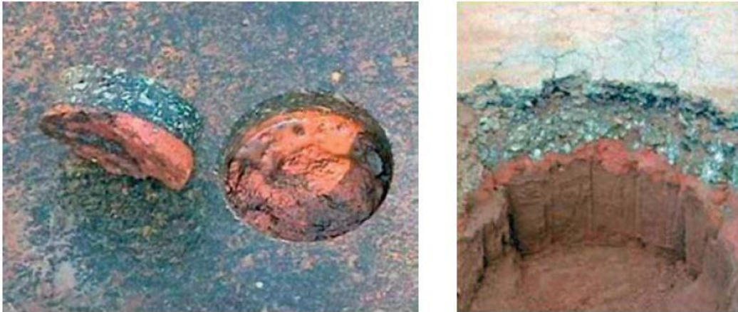
Figura 26 - Avaliação destrutiva por meio de escavação de valas
