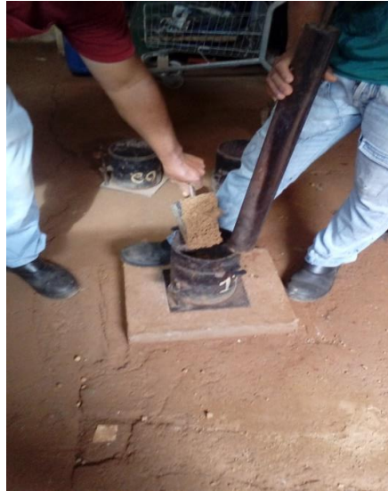
Figura 34 - Determinação do ensaio de compactação
