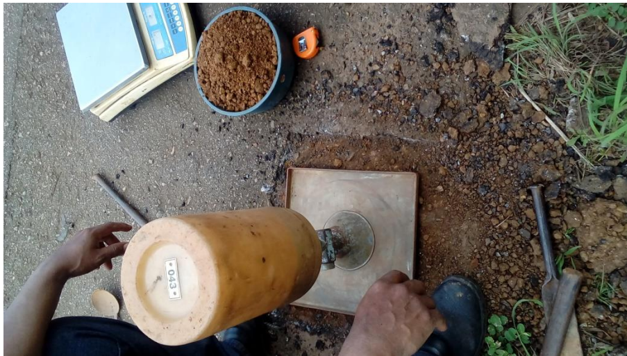
Figura 33 - Procedimento para determinação da densidade in situ
