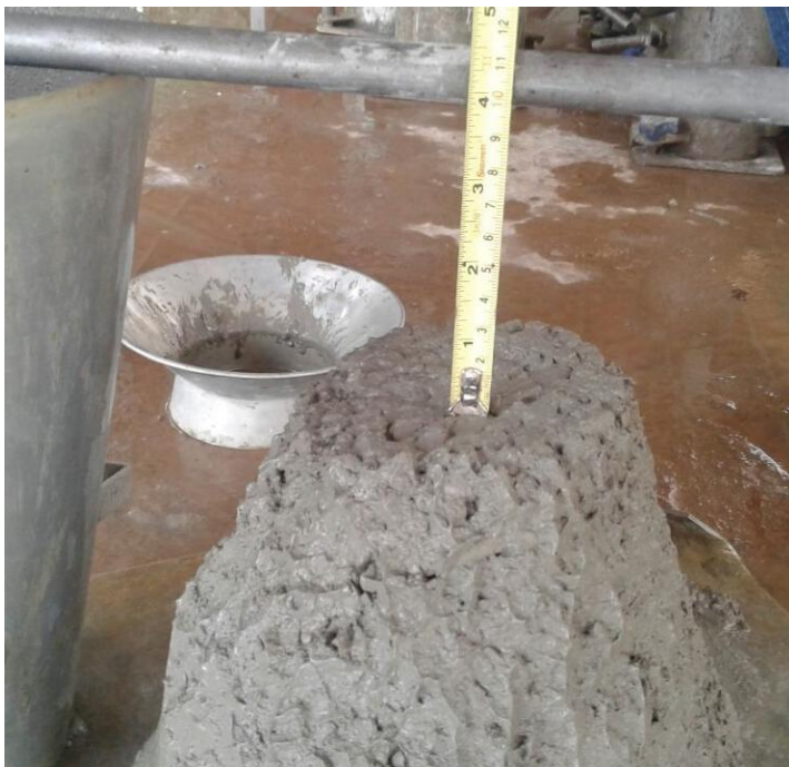
Figura 6: Teste abatimento do tronco de cone.
