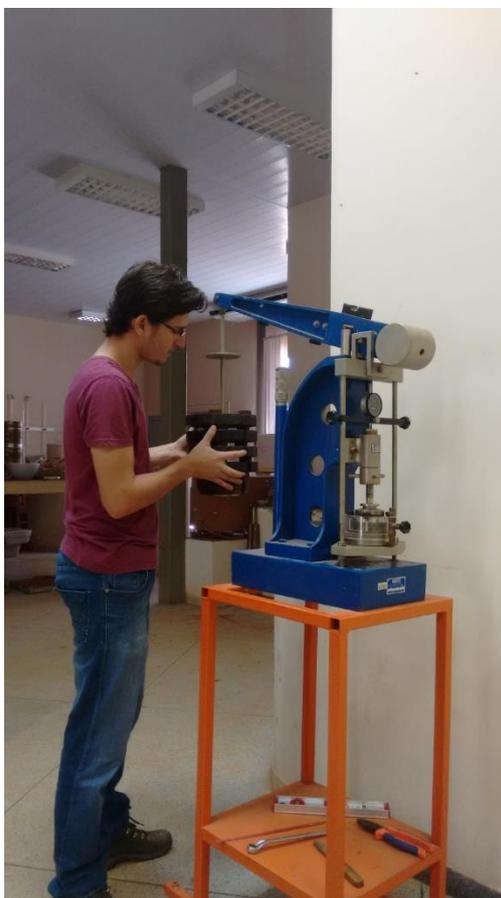
Após a realização dos ensaios e obtenção dos dados, é então calculado o potencial de colapso dos solos estudados por meio de critérios determinados por Jennings & Knight (1975) e também pelo método de Vargas (1978).
