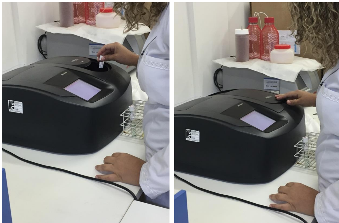
Figura 22 – Processo de leitura das amostras no espectrofotômetro.
