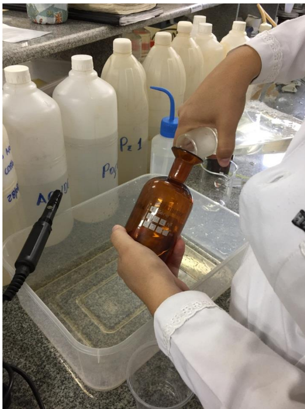
Figura 16 – Amostra sendo inserida no frasco de vidro para que pudesse ser armazenada no compartimento, para aguardo dos 5 dias corridos.
