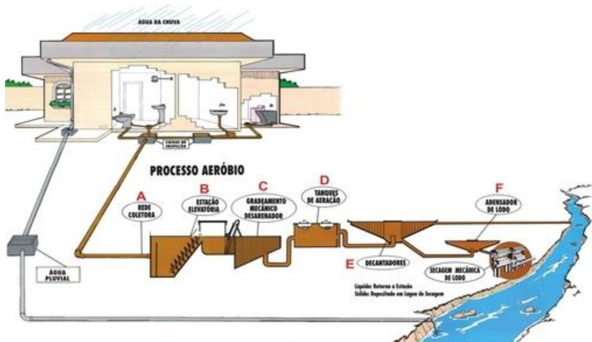
Figura 8 – Etapas do processo de tratamento aeróbio de efluente
