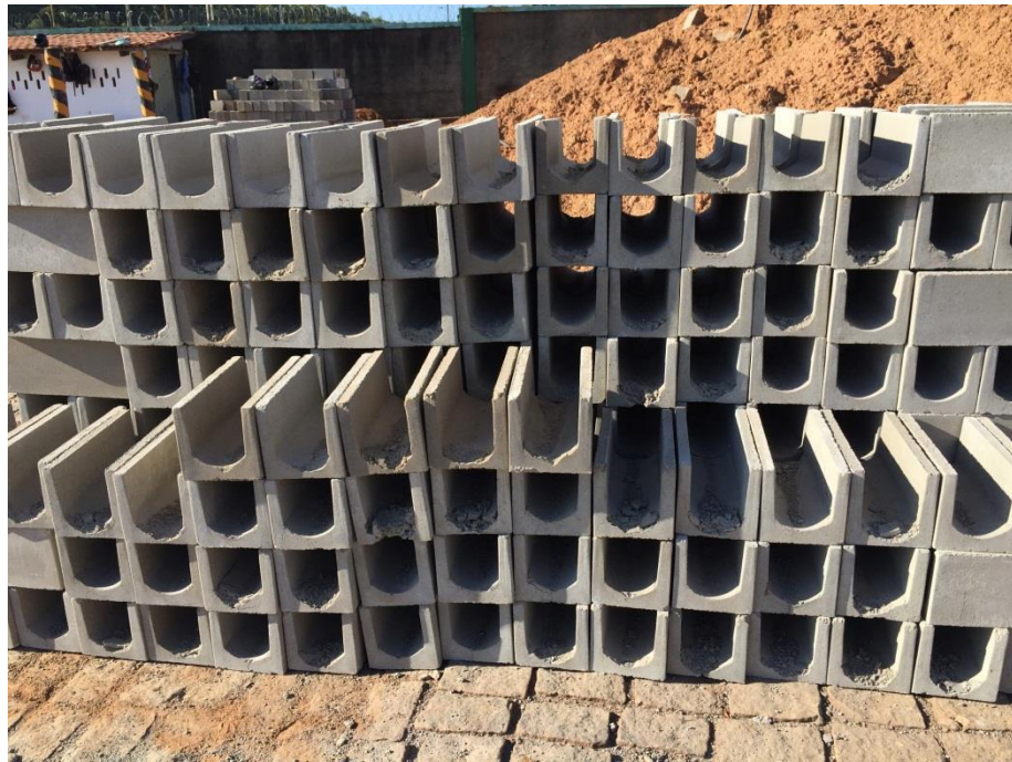
Figura 23 – Blocos ao fundo e Canaletas, ambos em concreto, para confecção dos tanques.
