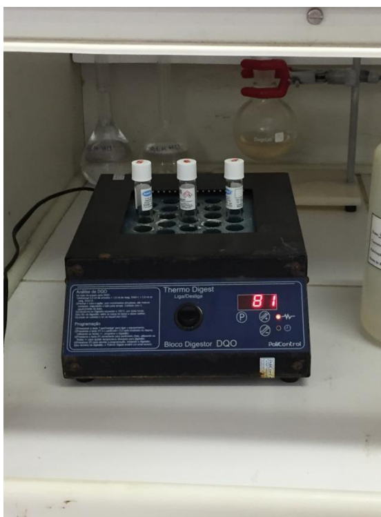
Figura 21 – Bloco Digestor, localizado em uma capela de exaustão.
