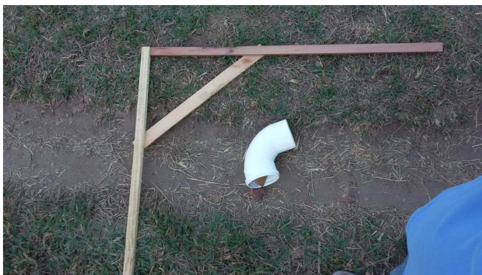
Figura 14 – Equipamento utilizado para medir altura
