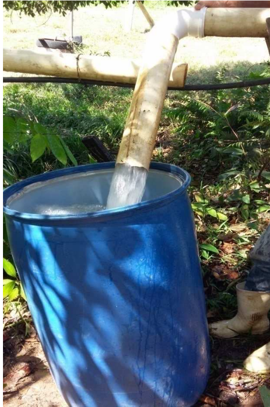
Figura 13 – Medição de vazão
