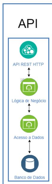
A figura 10 demonstra como foi construída a API (Application Program Interface), interface de acesso aos recursos do software. Ela demonstra o fluxo para acesso aos dados,
