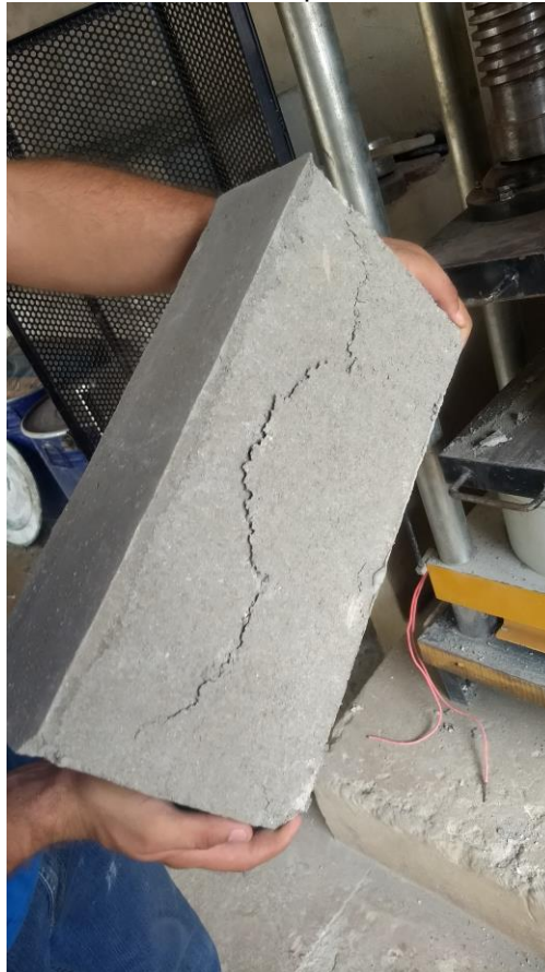
Figura 10 e 11 –Blocos de concreto sendo rompidos.
