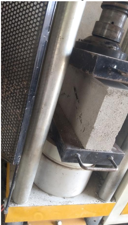
Figura 10 e 11 –Blocos de concreto sendo rompidos.
