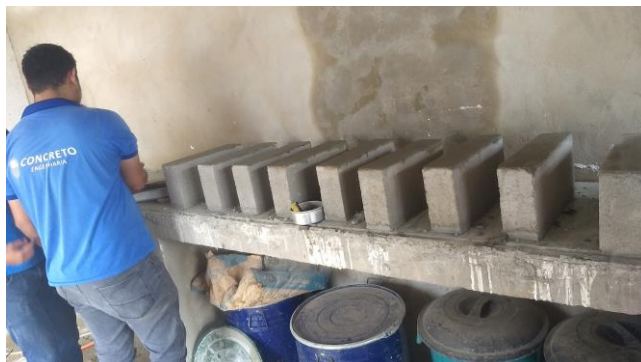
Figura 8 – Capeamento do bloco de concreto.
