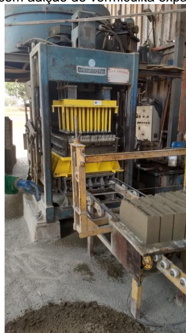
Figura 4 e 5 – Fabricação do bloco de concreto com adição de vermiculita expandida.
