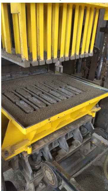
Figura 4 e 5 – Fabricação do bloco de concreto com adição de vermiculita expandida.
