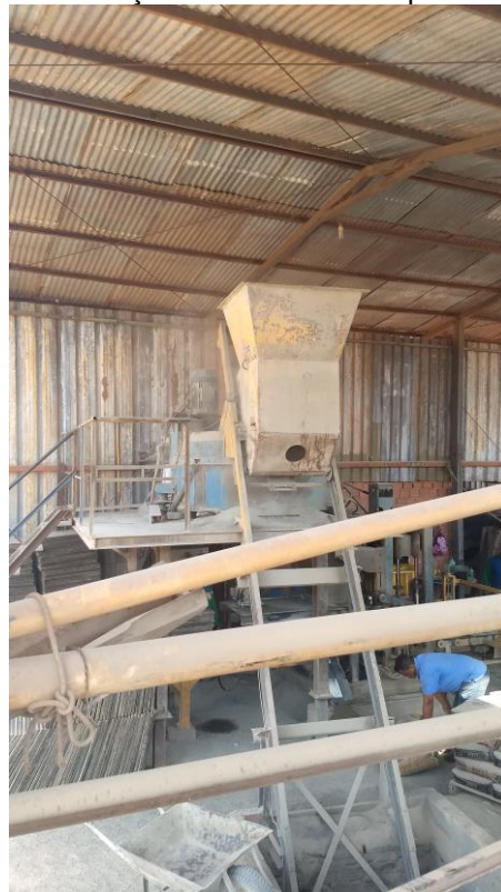
Figura 2 e 3 – Fabricação do bloco de concreto com adição de vermiculita expandida
