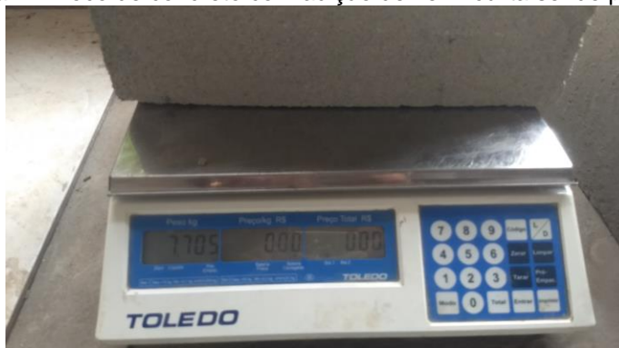
Figura 7 – Bloco de concreto com adição de vermiculita sendo pesado.
