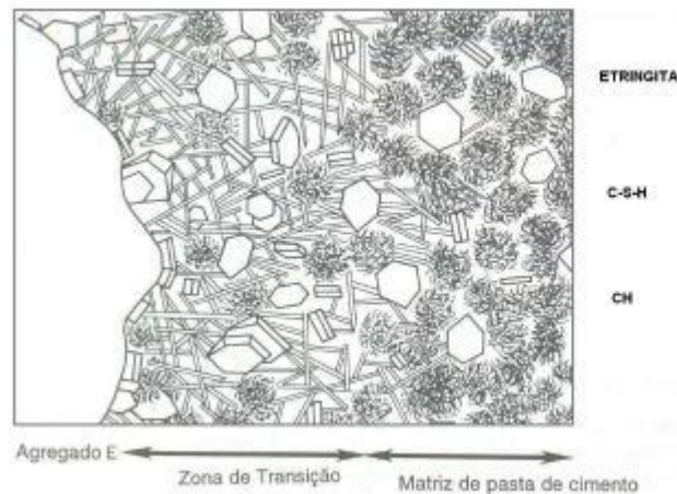
Figura 6 - Microestrutura do Concreto Convencional
