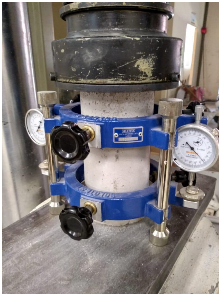
Figura 14 – Ensaio de Módulo de Elasticidade sendo realizado
