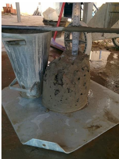
Figura 11 – Ensaio de abatimento do concreto.
