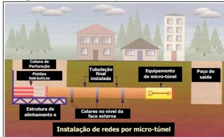
Figura 8: Processo de instalação do método de micro túnel.
