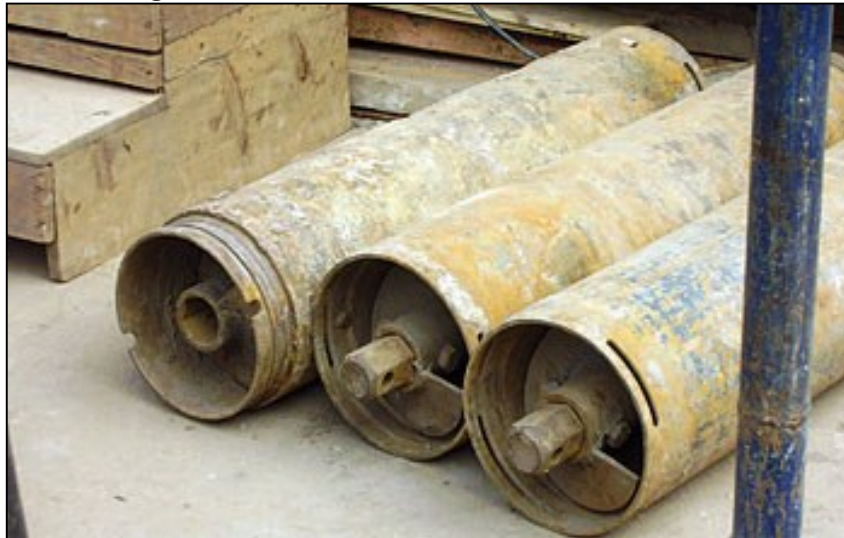
Figura 13: Tubos de camisa de aço e roscas helicoidal
