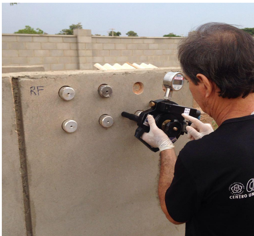
Figura 8 - Realização do ensaio de arrancamento à tração
