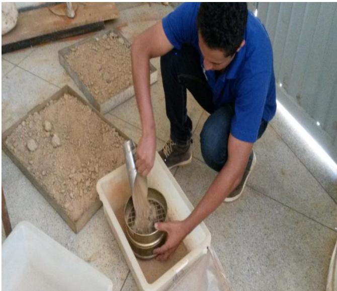
Foto 11: Retirada de pedregulhos por peneiramento
