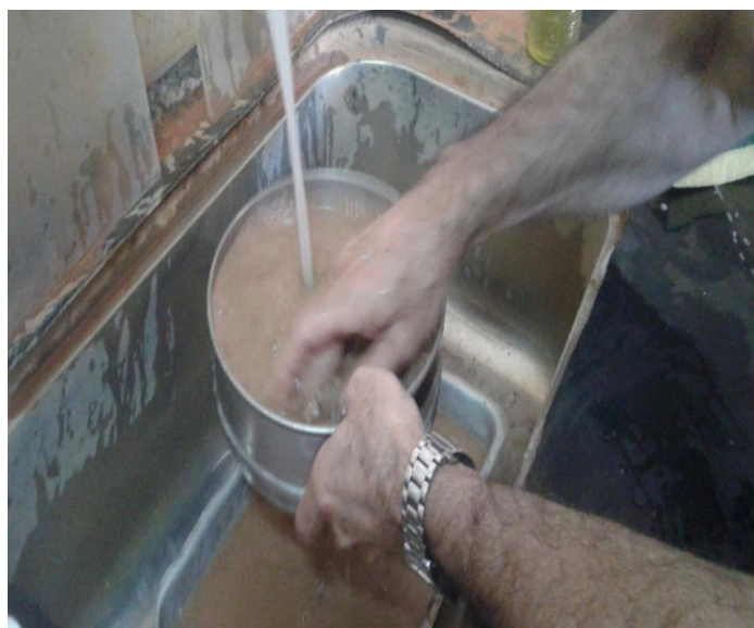
Figura 12: Lavagem do material retido na peneira #10;
