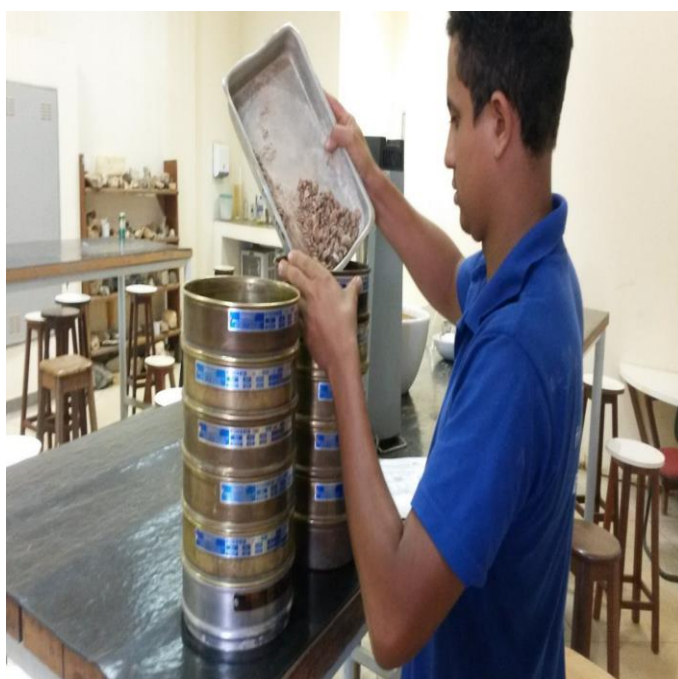
Figura 14: Execução de peneiramento
