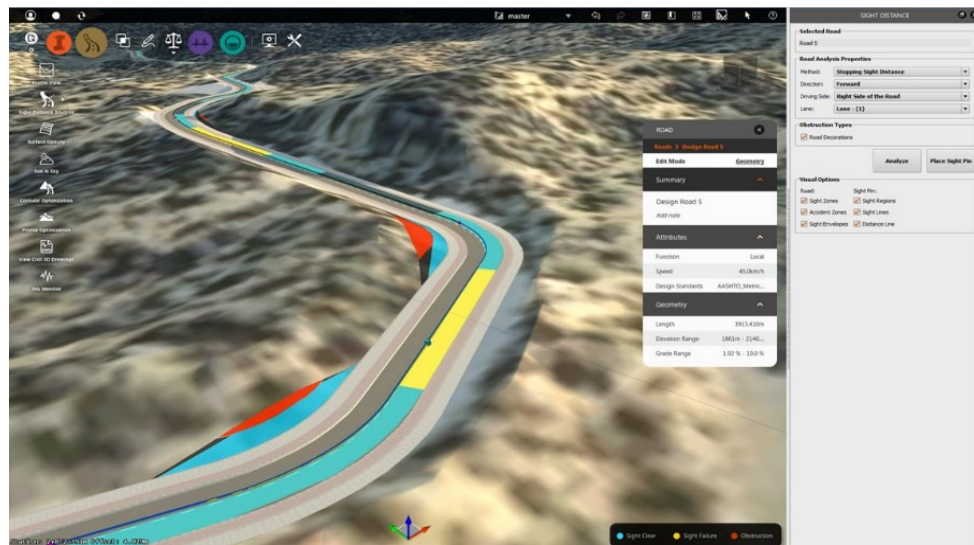
Figura 3. Análise da distância de visibilidade
