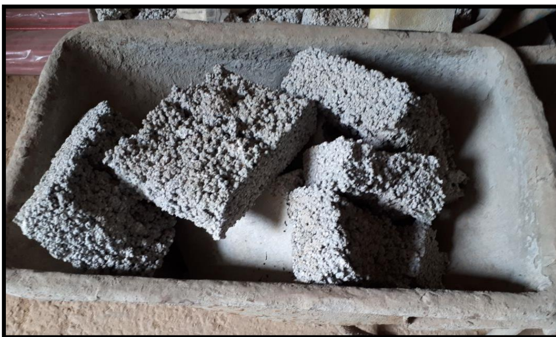
Figura 2 – Blocos de concreto com EPS triturado.
