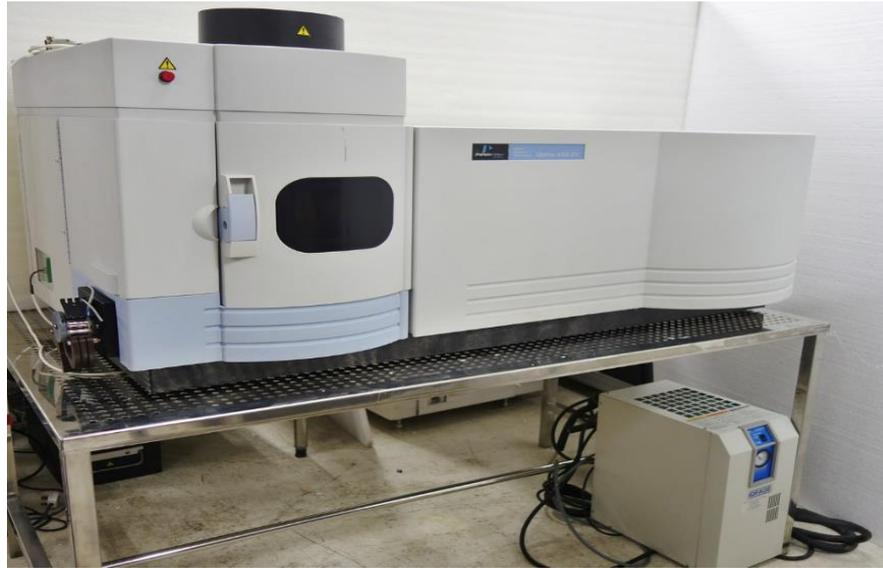
**Figura 8** - Ilustração do espectrômetro utilizado para quantificação de metais.
