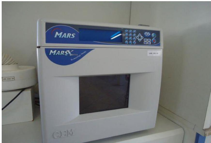
**Figura 7** - Ilustração forno micro-ondas Digestor MARS. (Site:labexata.com.br)
