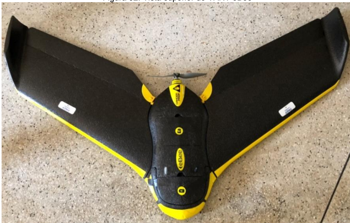
Figura 02: Vista superior do VANT eBee
