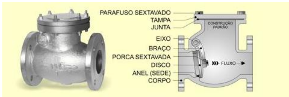
Figura 5 - Válvula de retenção tipo portinhola
