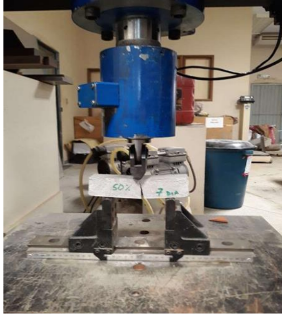
Figura 10 - Ensaio de resistência à tração na flexão
