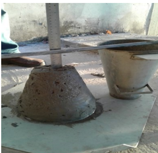
Figura 22- Ensaio do abatimento do tronco de cone
