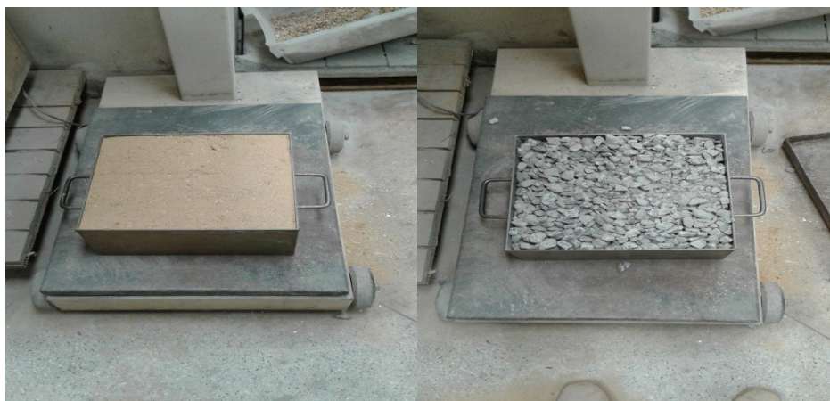
Figura 13- Ensaio de massa unitária
