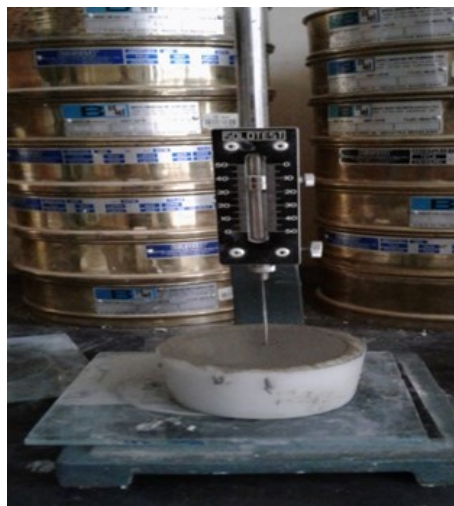
Figura 16- Ensaio do tempo de pega
