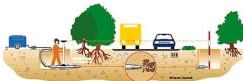
Figura 8 Perfuração por Percussão (Impact moling)
