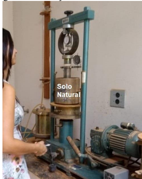
Figura 7: Execução do Ensaio de CBR
