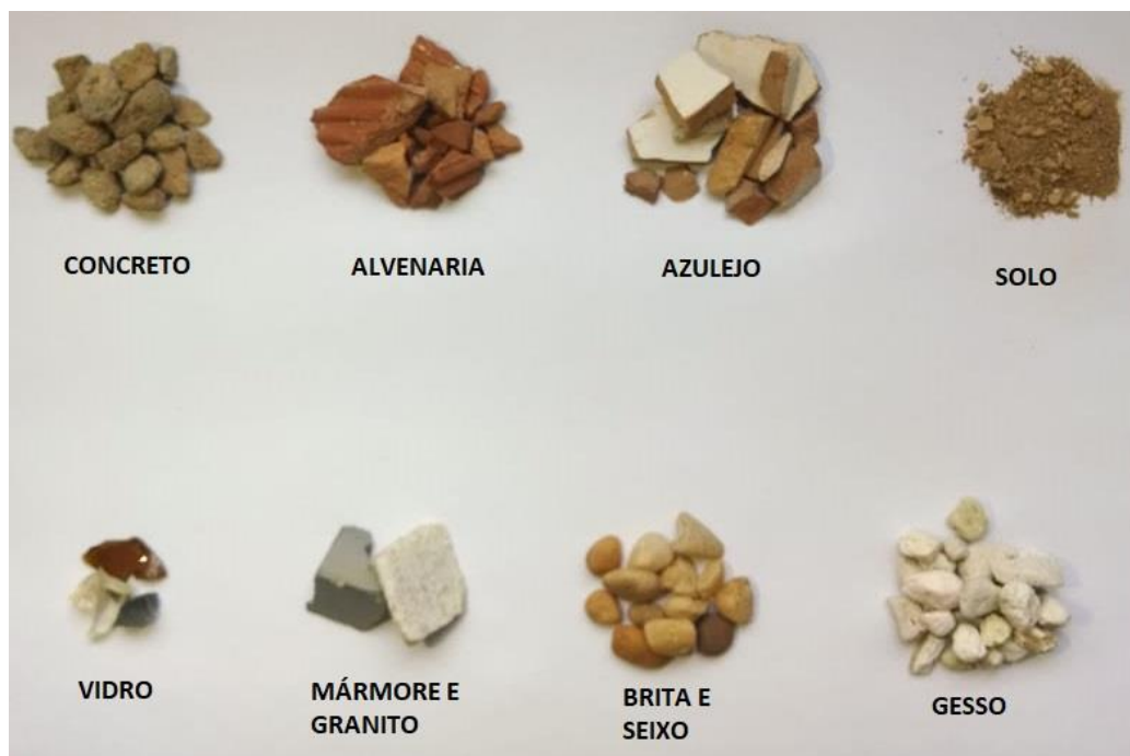
Figura 8: Componentes presentes no agregado de RCC
