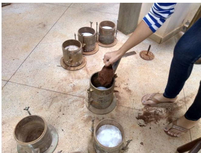
Figura 6: Execução do ensaio de compactação
