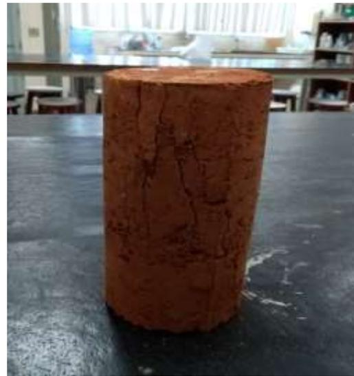
**b)** Corpo de prova rompido
