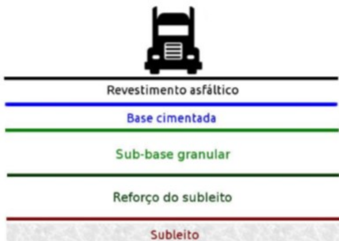
Figura 3: Estrutura de Pavimento Semirrígido
