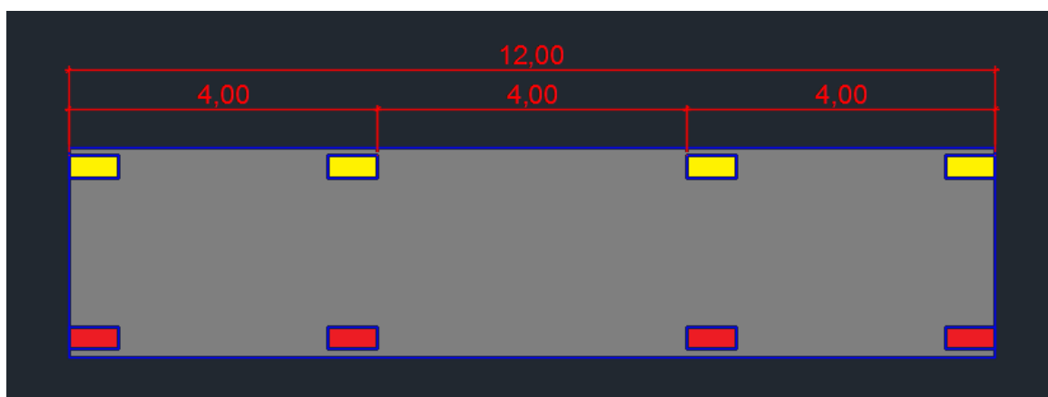
Figura 39- disposição dos aparelhos no bloco de encontro
