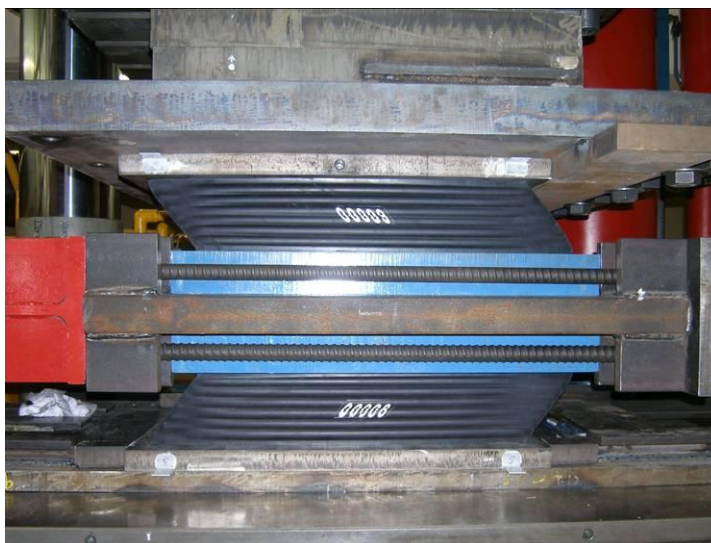
Figura 15- Comportamento do neoprene fretado ao cisalhamento
