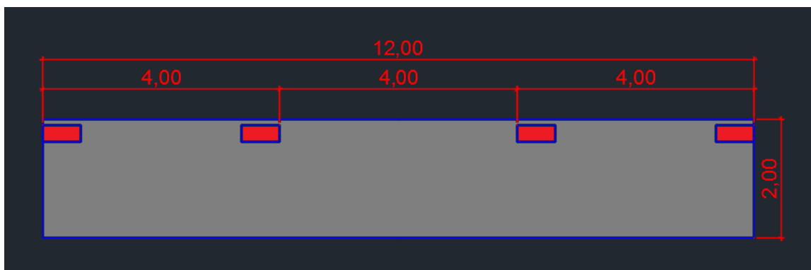
Figura 38- disposição dos aparelhos no bloco de concreto
