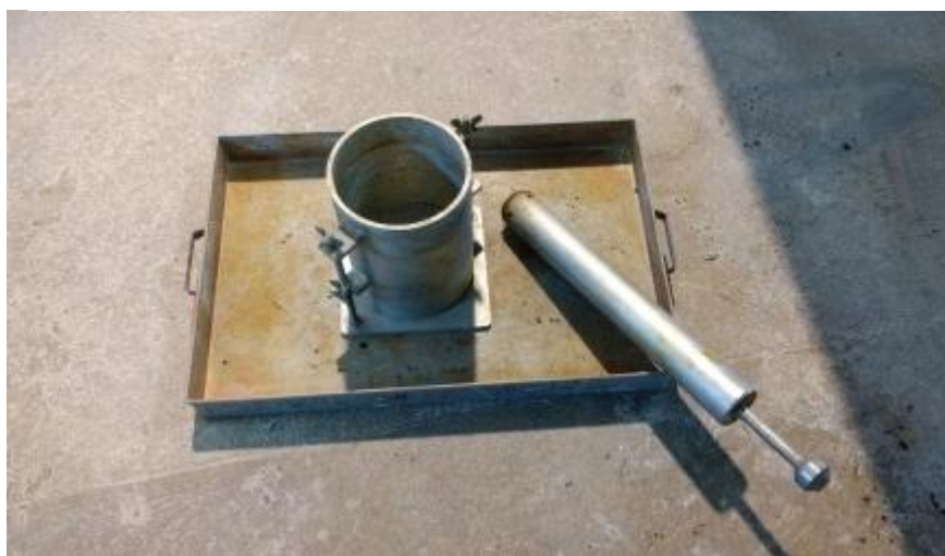
Figura 5: Ensaio de Compactação - Materiais
