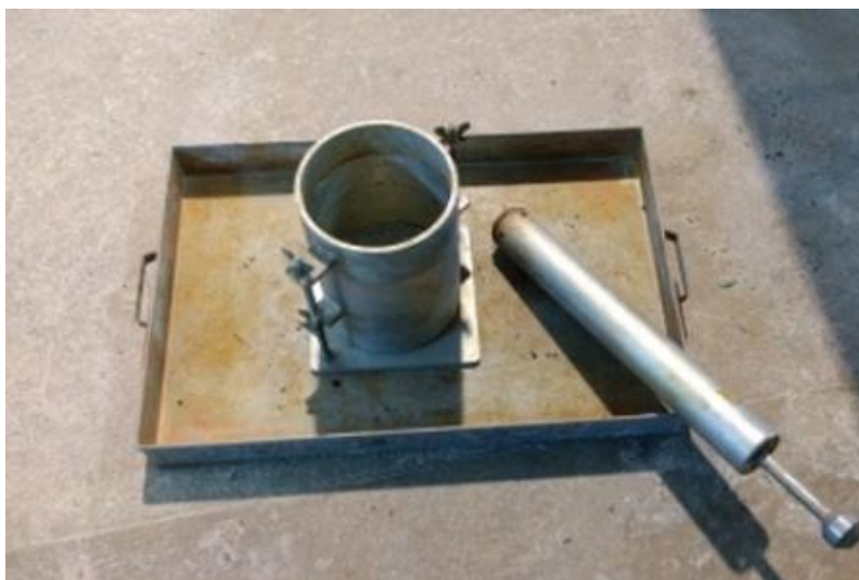
Figura 56: Compactação do solo
