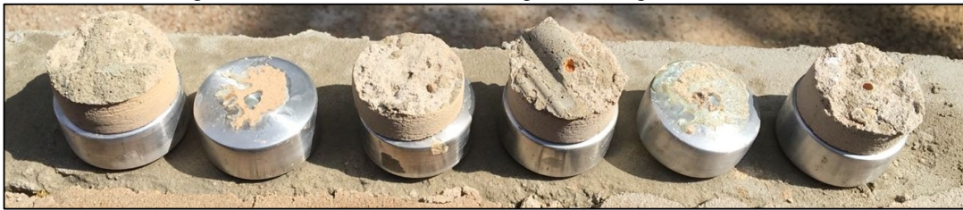
Figura 45 - Diferentes modelos de rupturas da argamassa AR50%
