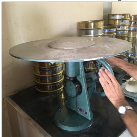
Figura 40 - Procedimento do ensaio de índice de consistência das argamassas na mesa “flow table”
