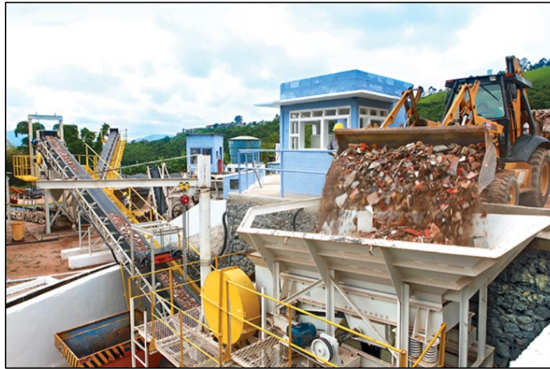
Figura 14 - Processo de britagem de materiais
