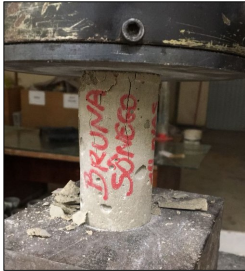
Figura 42 - CP submetido à compressão axial
