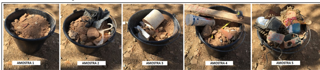
Figura 29 - Amostras coletadas no local de descarte de RCC
