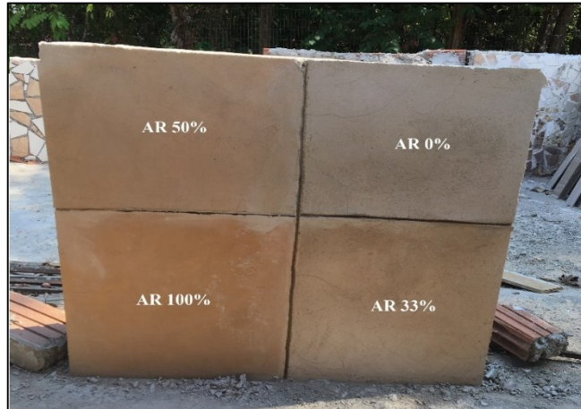
Figura 43 - Mini-parede com aplicação de 4 traços de argamassa
