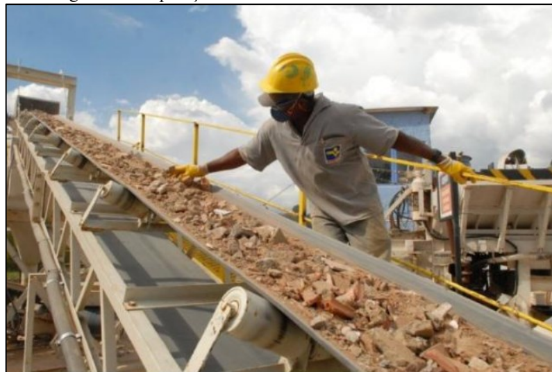
Figura 15 - Separação manual realizada na esteira do britador
