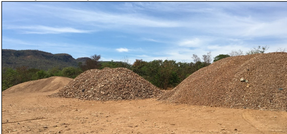
Figura 34 - 3 fases granulométricas de resíduos de construção civil reciclados
