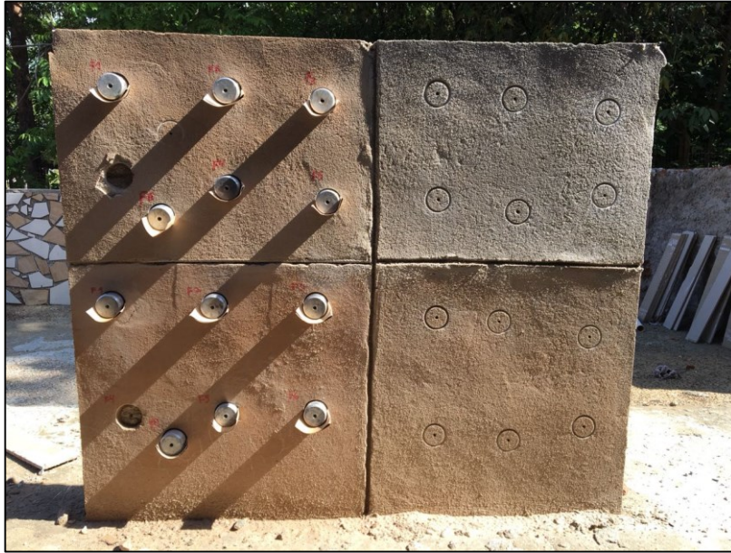
Figura 44 - Mini-parede com pastilhas coladas antes de sofrerem ruptura com dinamômetro
