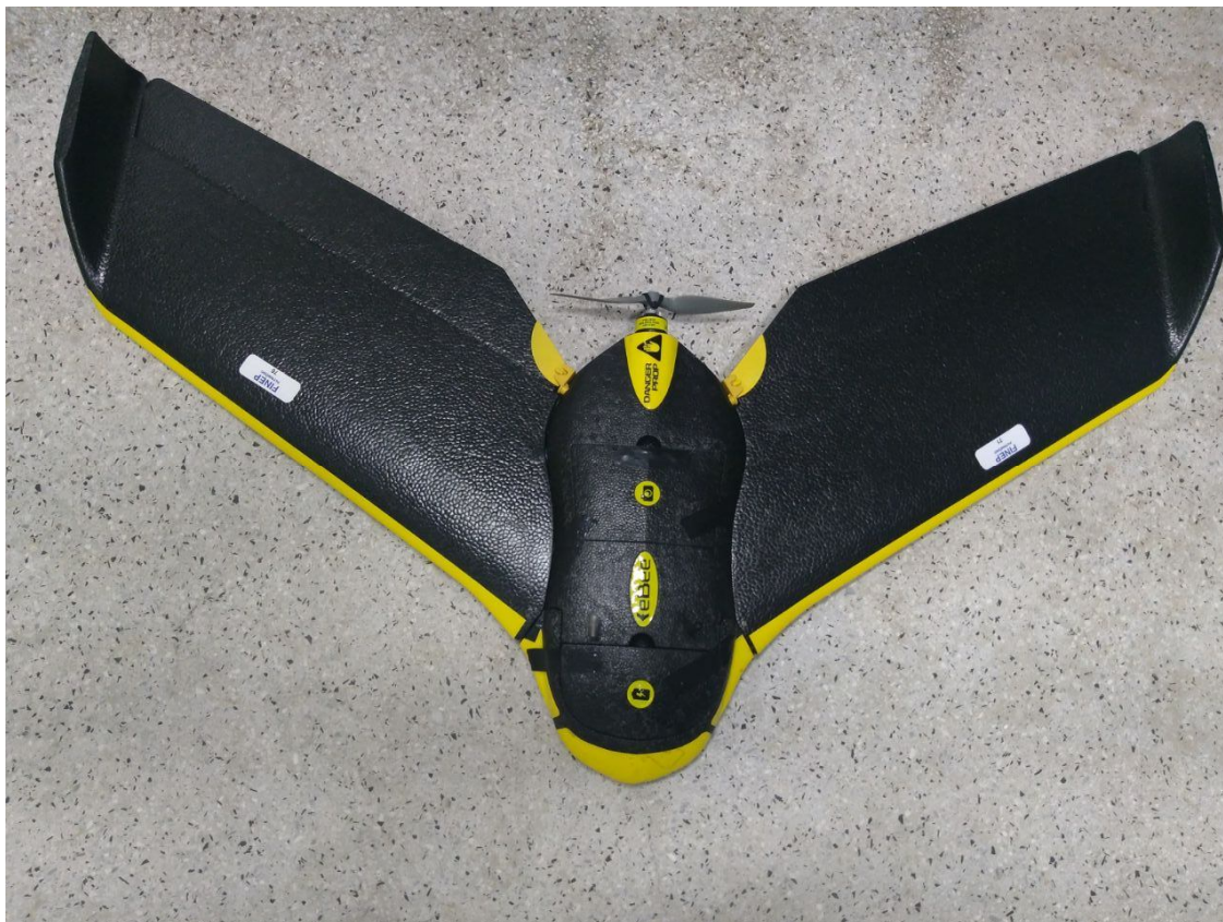
Figura 2. VANT modelo eBee
