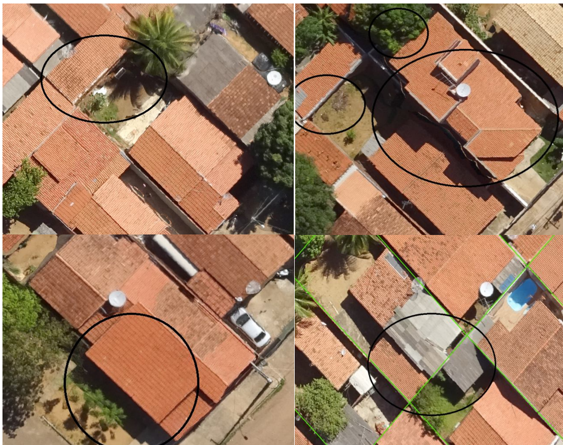
Figura 11. Muros desalinhados, construção anexa e beiral.
