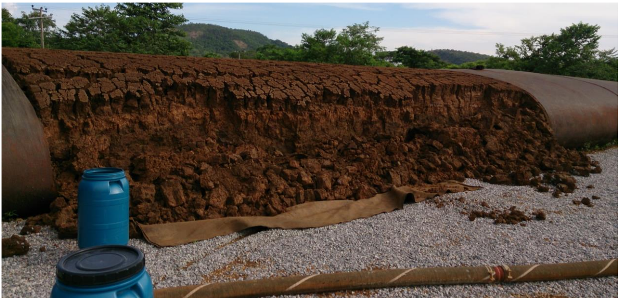
Figura 16: Lodo da ETA 006 condicionado no bag.
