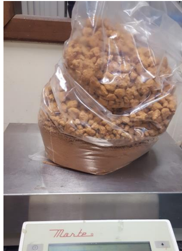
Figura 16 - Separação da amostra em porção de 7 kg para realização dos ensaios
