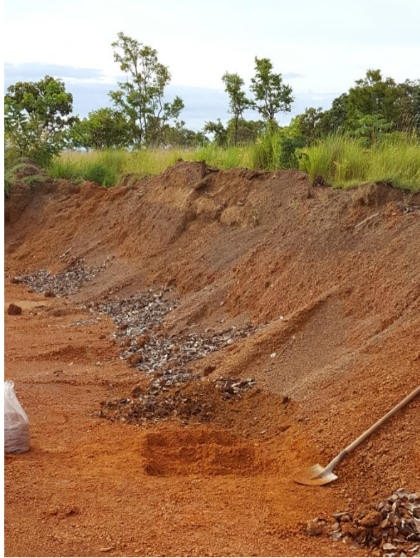
Figura 11 - Escavação da jazida para coleta das amostras
