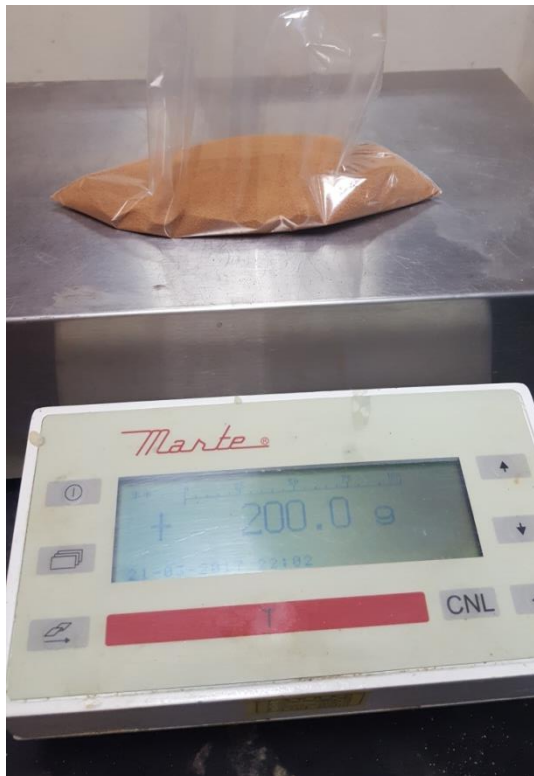
Figura 18 - Porção de 200 g para realização dos ensaios de limite
