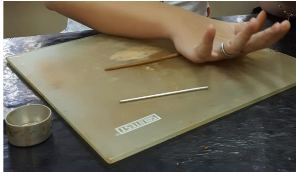
Figura 27 - Execução do ensaio de Limite de Plasticidade
