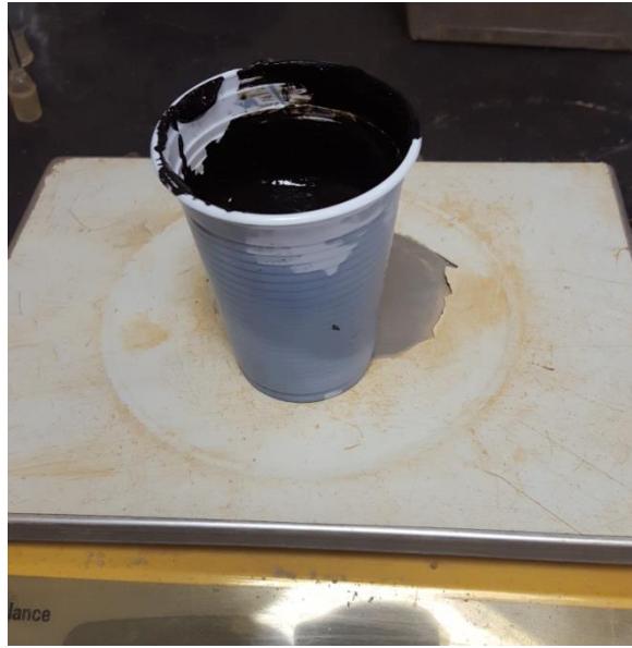
Figura 30 - Massa de emulsão utilizada na dosagem de 2%
