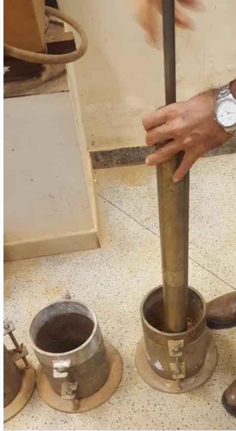
Figura 37 - Compactação com auxílio do soquete metálico
