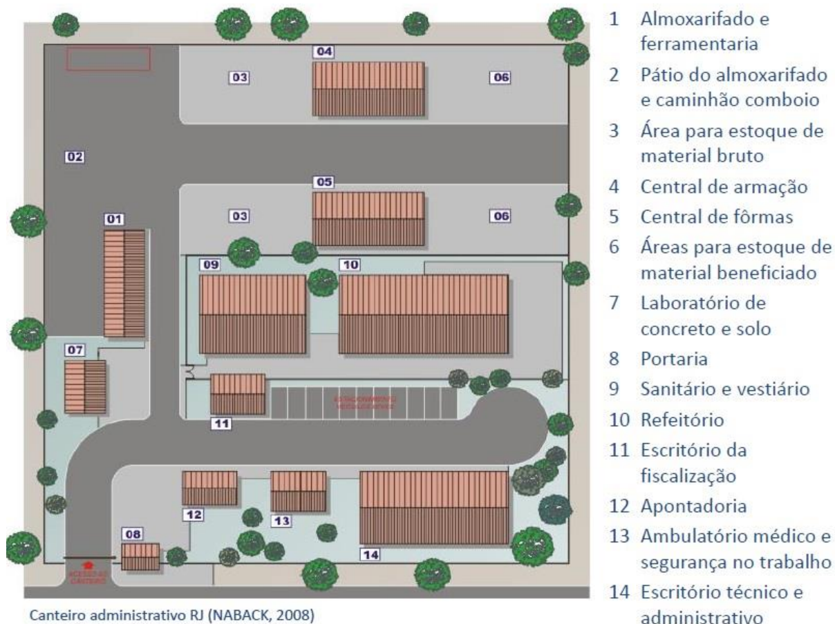
Figura 2: Canteiro de obras
