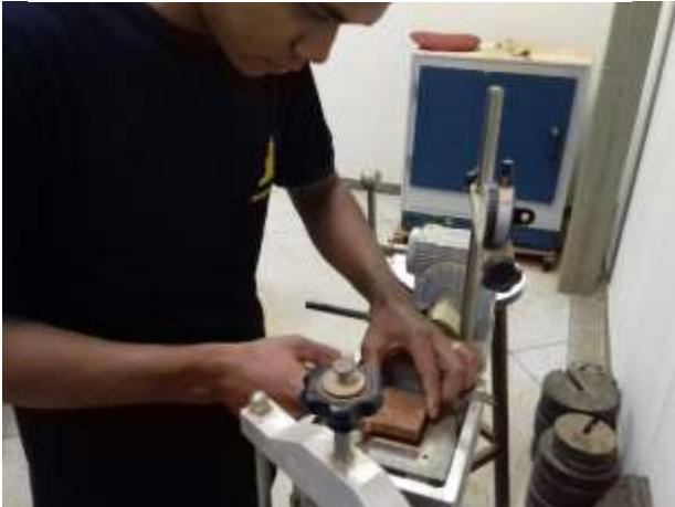
**Figura 45** - Instalação da conjunto superior da caixa bipartida
