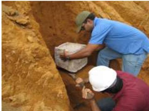
**Figura 4 –** Confinamento da amostra indeformada
