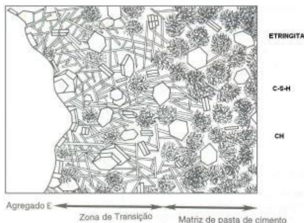
Figura 5 - Microestrutura do Concreto Convencional
