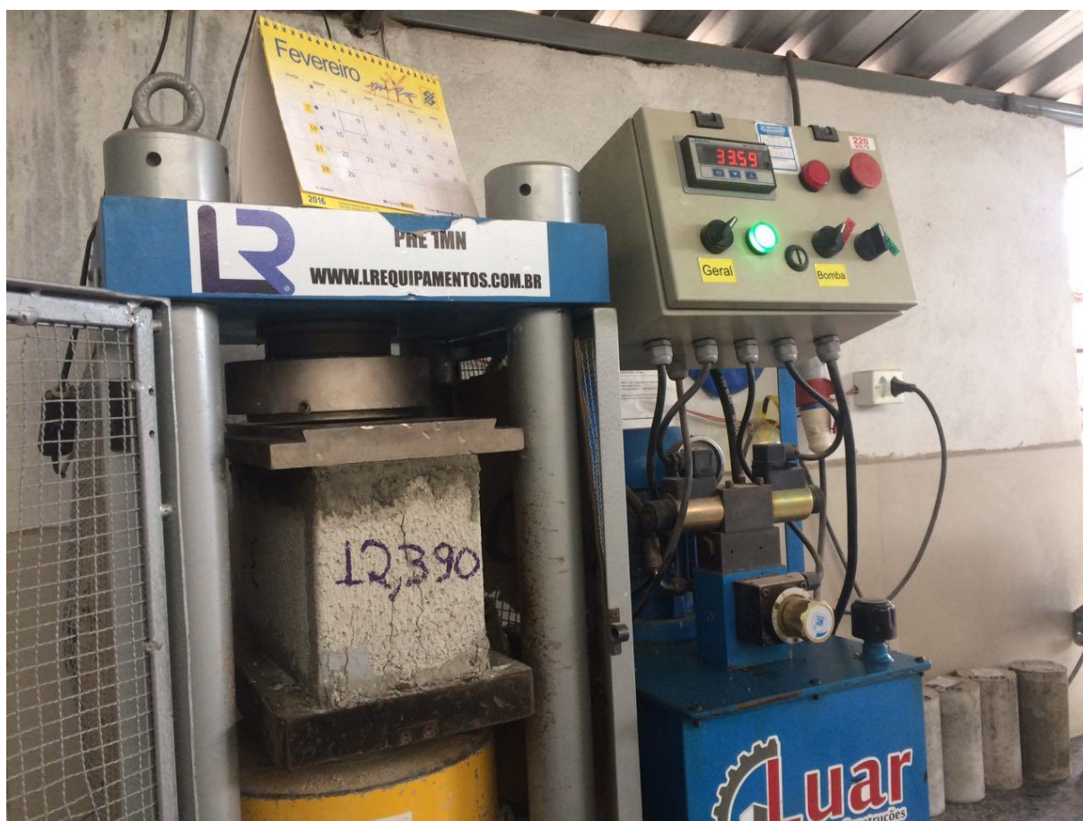
Figura 11 - Ensaio de Resistência à compressão CP de nº 4, T2.
