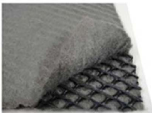
Figura 3 – Geocompostos (Georrede com Geotêxtil não tecido)
