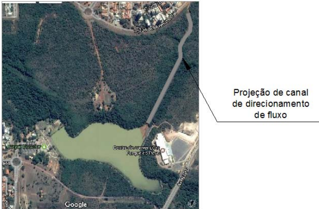
Figura 30 – Projeção do canal de direcionamento de fluxo
