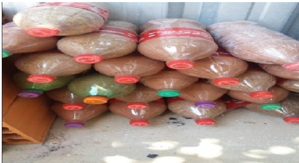
Figura 22 - Condicionamento do Pó de Serragem nas Garrafas PET
