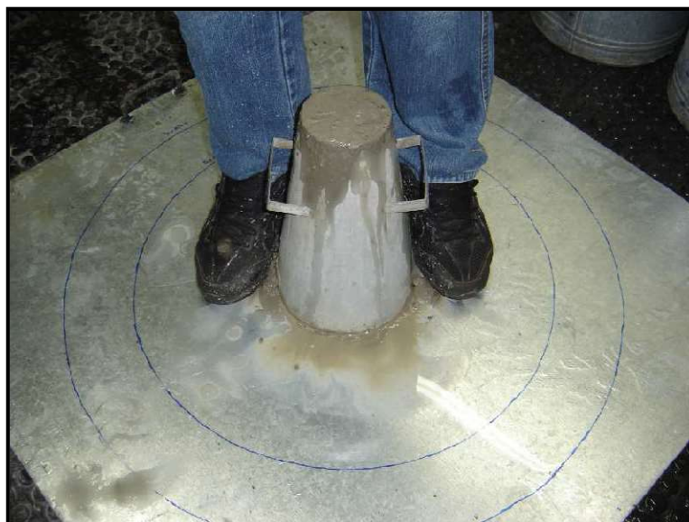
Figura 10 - Cone de Abrams já preenchido.
