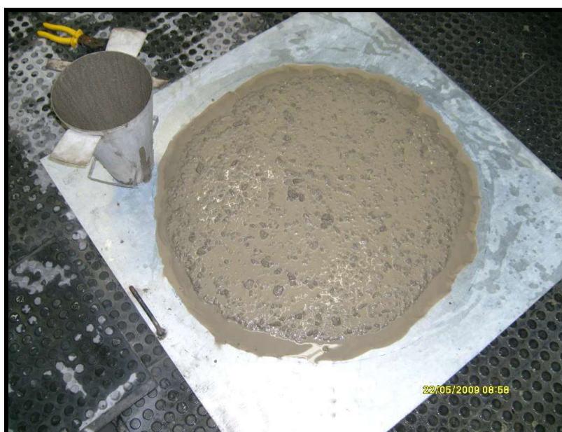
Figura 11 - Escoamento ocorrido após o içamento do cone.
