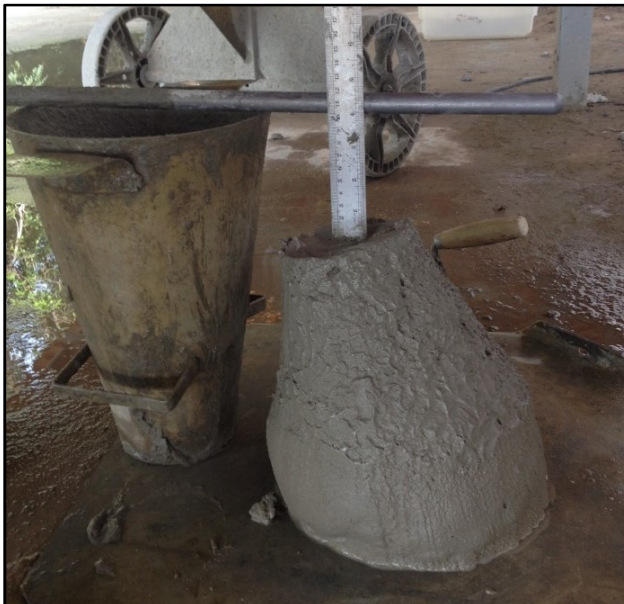
Figura 15 - Slump Test
