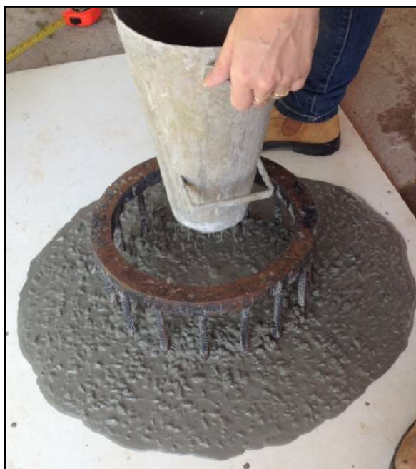
Figura 17 – Ensaio Anel J
