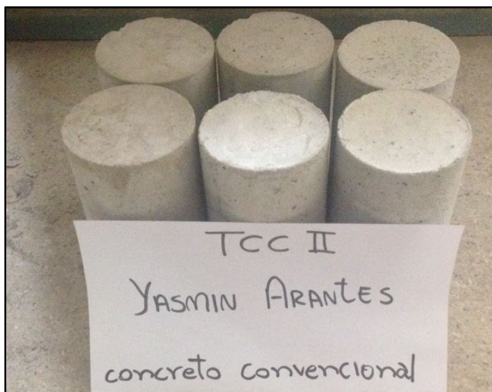
Figura 18 - Corpos de Prova para Ensaio de Compressão
