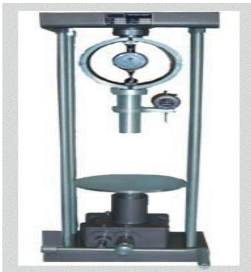
Figura 4 - Prensa para índice de suporte Califórnia (CBR)
