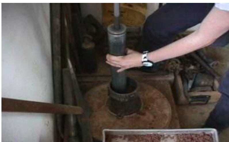
Figura 20 - Moldagem dos corpos de prova
