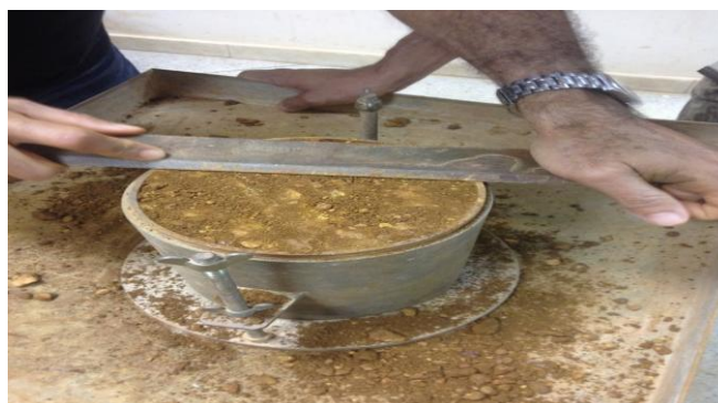
Figura 17 - Ensaio de compactação
