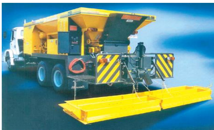
Figura 5 Exemplo de equipamento para produção e aplicação de lama asfáltica
