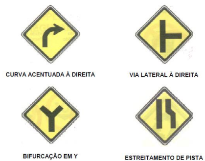
Figura 29 – Sinais de advertência
